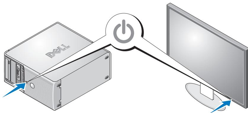
Appuyez sur le bouton d'alimentation du système et sur celui du moniteur. Les voyants d'alimentation doivent s'allumer. Réglez le moniteur jusqu'à ce que l'image affichée soit correcte.
