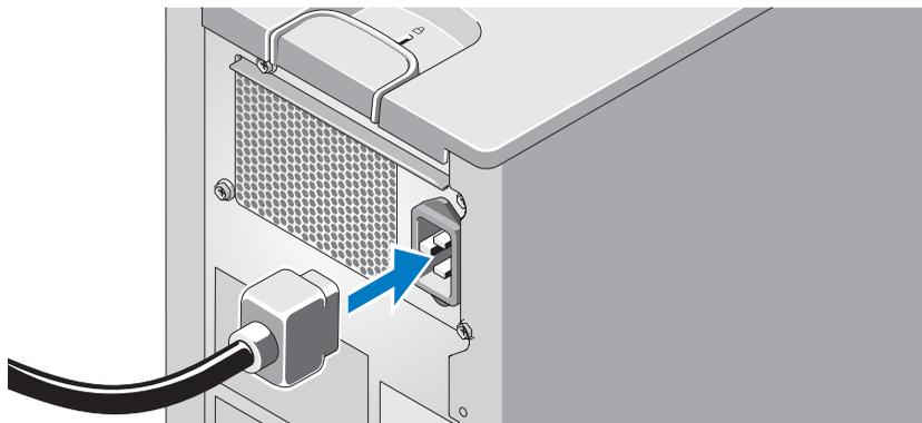
Conecte o cabo de alimentação ao sistema. Em seguida, conecte a outra extremidade do cabo de alimentação a uma tomada elétrica aterrada ou a uma fonte de energia separada como, por exemplo, uma UPS (Uninterruptible Power Supply [fonte de alimentação ininterrupta]) ou uma PDU (Power Distribution Unit [unidade de distribuição de energia]).
