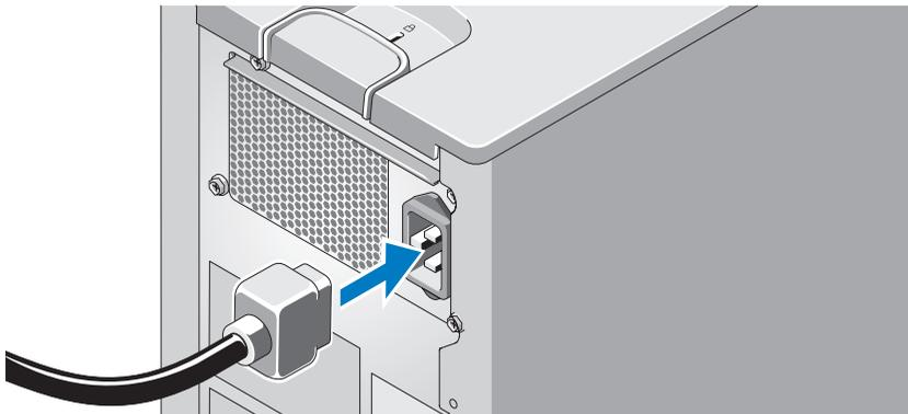
Branchez le câble d'alimentation sur le système. Branchez ensuite l'autre extrémité du câble sur une prise de courant mise à la terre ou sur une source d'alimentation autonome (onduleur ou unité de distribution de l'alimentation [PDU]).
